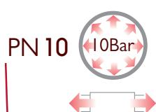
Presión máxima con servicio de tuberías sujetado
